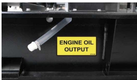
Рисунок 6.1: Пробка сливного отверстия для масла
